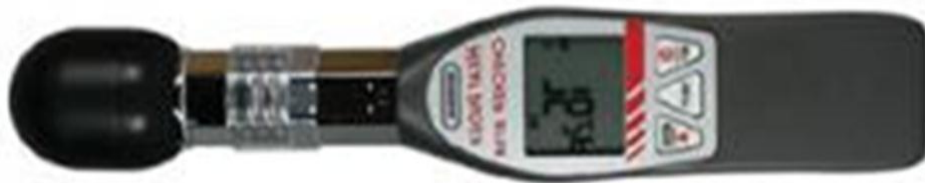
Slika 3a. Uređaj za mjerenje IVGT indeksa
